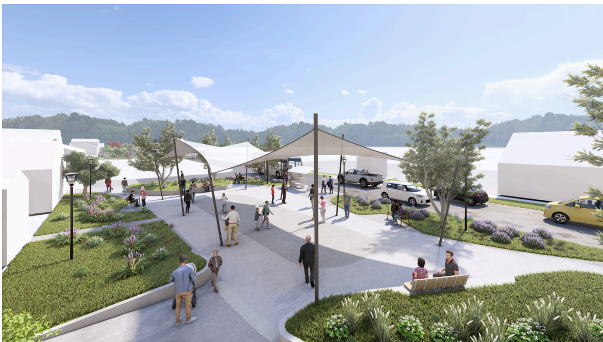
Cubierta: Tenso estructura autoportante con tela resistente al uso exterior.
