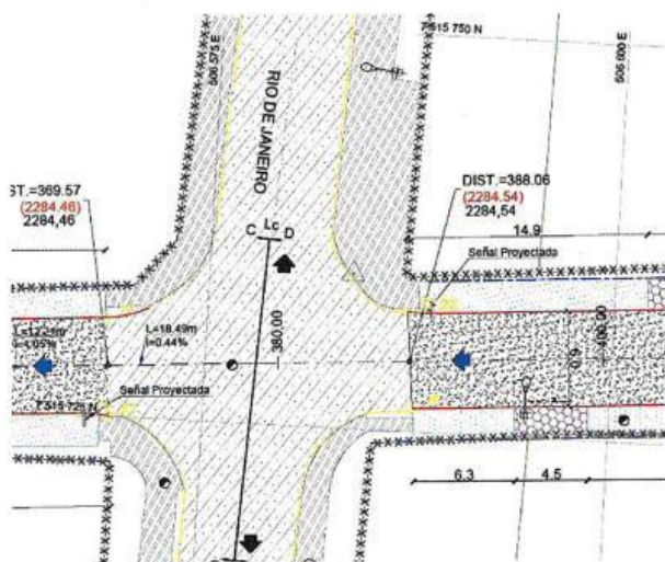
Imagen 22. Intersección de calle General Salvo con calle Río de Janeiro proyectada, donde se definen límites de carpeta asfáltica por lado oriente y poniente.
