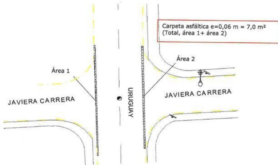
Imagen 13. Reposición de calzada asfáltica en calle Javiera Carrera con calle Uruguay, fajas en paralelo a límites de obras por lado oriente y poniente
