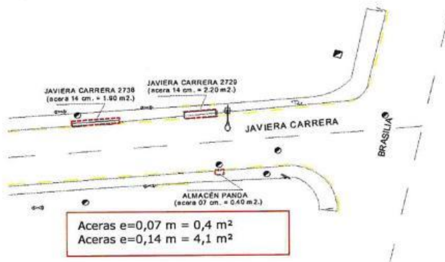
Imagen 6. Aumentos de obra. Aceras de hormigón en Javier Carrera.
