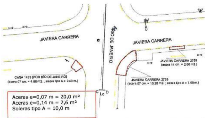
Imagen 7. Aumentos de obra. Aceras de hormigón y soleras tipo A en calle Javier Carrera con calle Río de Janeiro.
