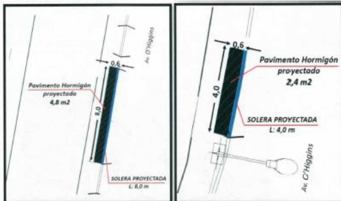
Imagen 10: rebaje de solera para acceso estacionamientos. (izq) 2 estacionamientos, (der) 1 estacionamiento.
