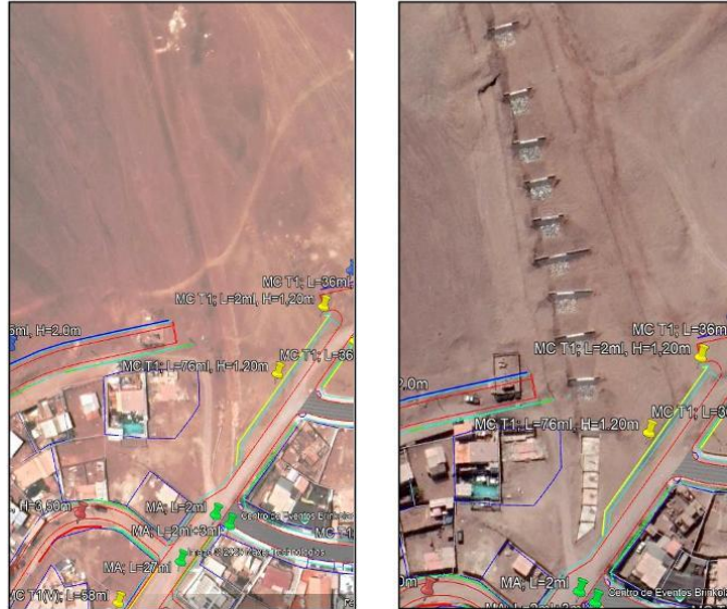
Quebrada año 2020 sin Piscinas Aluvionales y año 2021 con Piscinas Aluvionales (Planta Diseño Geométrico importado en .kmz de Google Earth)
