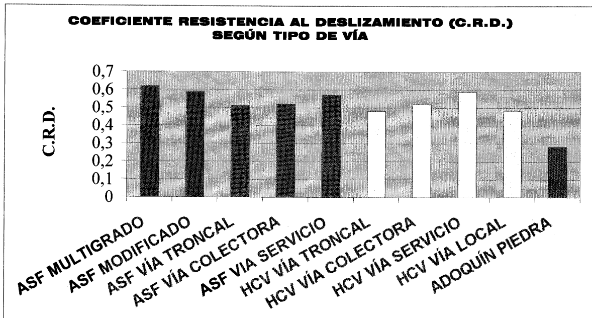
Figura 8 Experiencia nacional SERVIU RM. Coeficiente de resistencia al deslizamiento mediante péndulo británico.
